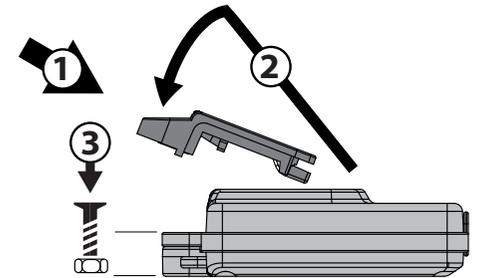
1. Прилагая усилие, вставьте крышку в корпус
